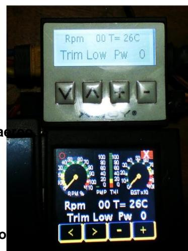
Entrambi i display includono schermate dedicate per il funzionamento del motore, il controllo della radio, la causa dell'ultimo arresto e altre operazioni speciali della turbina.
