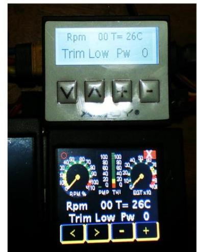
Beide Anzeigen umfassen spezielle Bildschirme für den Motorbetrieb, die Funkprüfung, den Grund für die letzte Abschaltung und andere spezielle Turbinenvorgänge.
