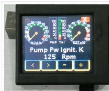
Als nächstes erfolgt die Einstellung der minimalen Pumpengeschwindigkeit beim Start.
